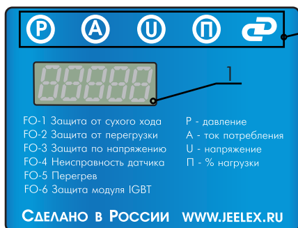
Рисунок 3. Блок управления насосом
